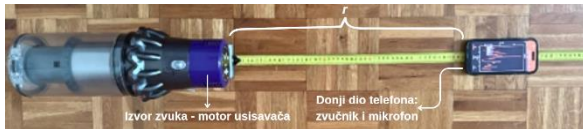
Slika 9. Eksperimentalni postav za mjerenje relativne promjene razine zvučnog tlaka u ovisnosti o udaljenosti od izvora u zatvorenom prostoru
