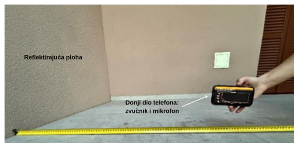
Slika 5. Eksperimentalni postav za određivanje brzine zvuka u zraku metodom refleksije na otvorenom prostoru.
