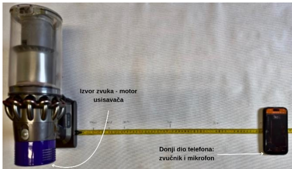
Slika 11. Nepovoljan položaj pametnog telefona pri mjerenju razine zvučnog tlaka
