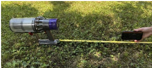
Slika 10. Eksperimentalni postav za mjerenje relativne promjene razine zvučnog tlaka u ovisnosti o udaljenosti od izvora na otvorenom prostoru
