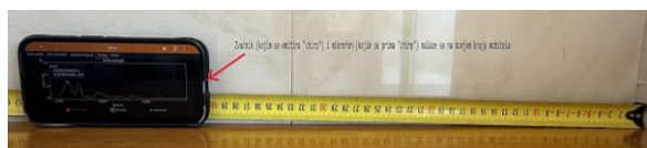
Slika 4. Eksperimentalni postav za određivanje brzine zvuka u zatvorenom prostoru
